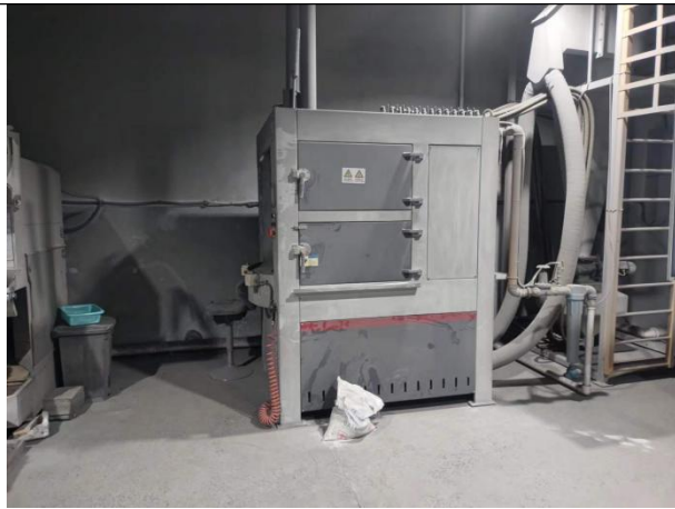
图3.3 喷砂工序设备自带环保装置（滤袋除尘）
