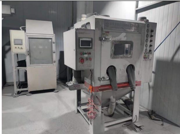
图3.1 磨削工序设备自带环保装置（滤袋除尘）
