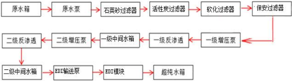
图2-3 纯水制备间工艺流程图
