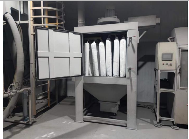
图3.2 喷砂工序设备自带环保装置（滤袋除尘）
